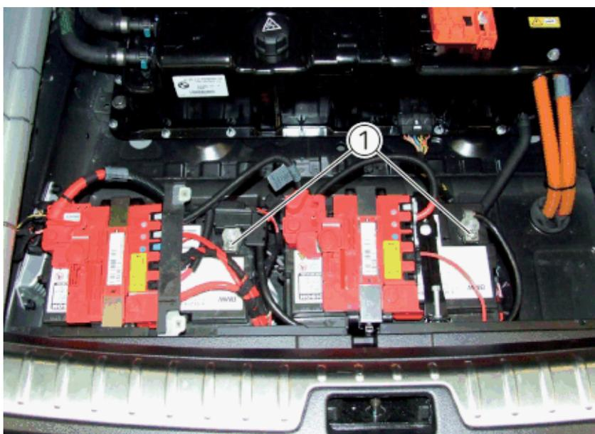
Ослабить гайки (1) и вытянуть вверх минусовые провода аккумуляторной батареи.
