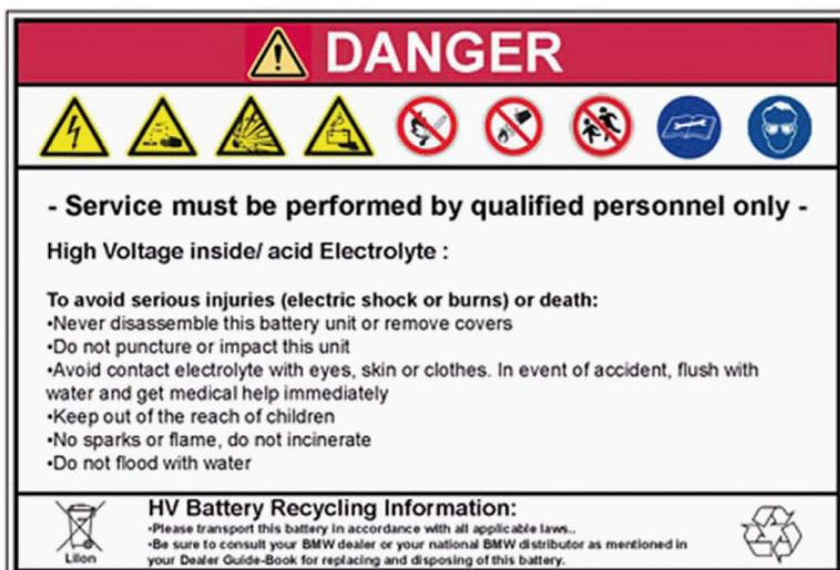
Маркировка остальных высоковольтных деталей:
