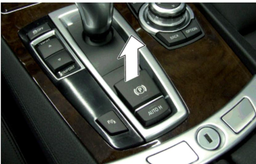
Сдвинуть вверх выключатель электрического стояночного тормоза.
