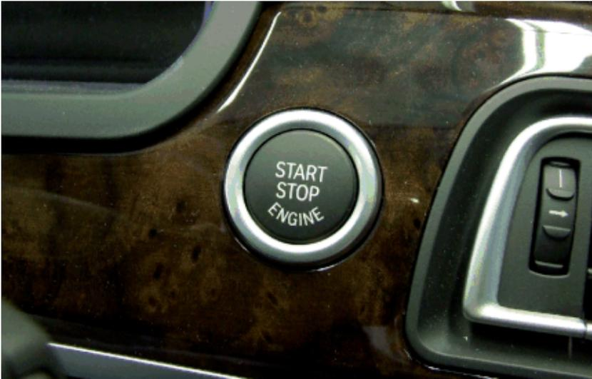
Для выключения зажигания при работе двигателя или с активной индикацией на панели инструментов нажать кнопку "START STOP ENGINE".
