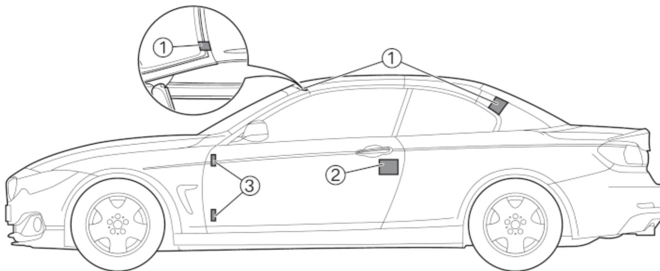
1. Поверхности обозначают области, в которых возможно отделение крыши:
