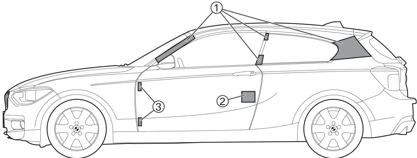
1. Поверхности обозначают области, в которых возможно отделение крыши. Необходимым условием для разрезания кузова являются современные мощные ножницы. Устаревшие гидравлические режущие устройства могут не справиться с такой работой.
