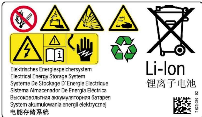
Kennzeichnung der restlichen Hochvolt-Bauteile:
