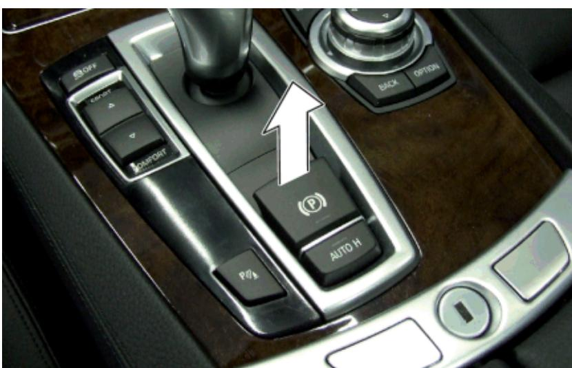
Сдвинуть вверх выключатель электрического стояночного тормоза.
