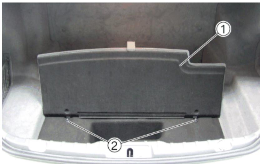
Открыть крышку багажника и поднять обшивку пола багажного отделения (1).
