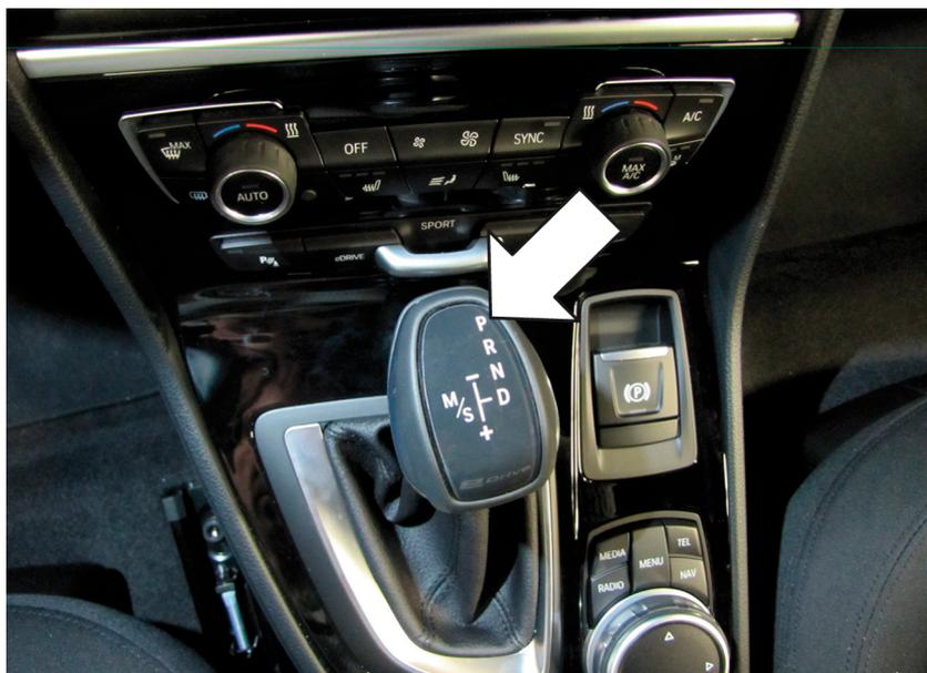
Schalter für elektrische Parkbremse nach oben ziehen.
