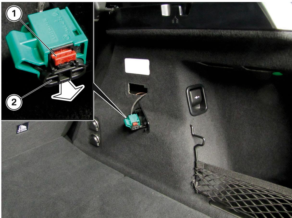
Das Hochvolt-System ist deaktiviert, wenn die Bohrung 1 durchgängig frei ist.
