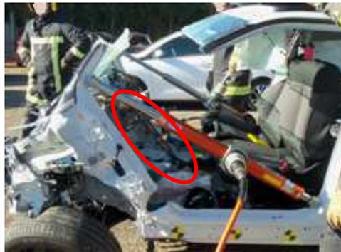
3/ Abstützung: unter der Mittelkonsole; diese Stütze muss zum Wegklappen des Frontmoduls durchtrennt werden.
