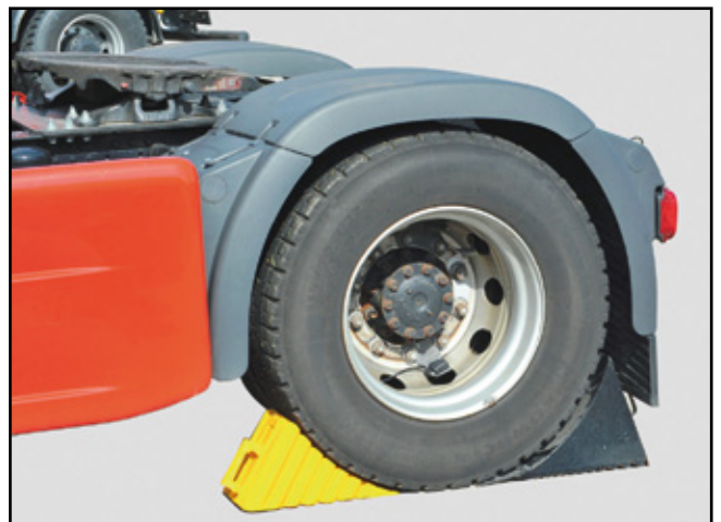
Hinterachse gesichert mit Radkeilen
