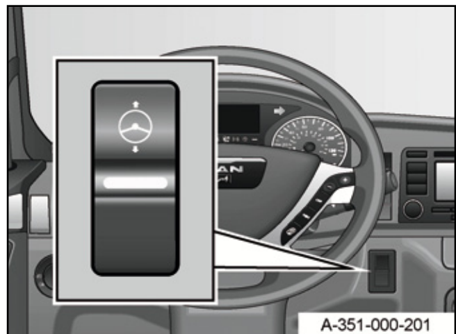
Wipptaster Lenkrad einstellen
