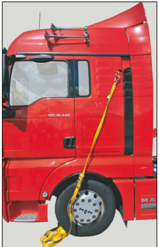
Zurrgurt am Rad befestigen
