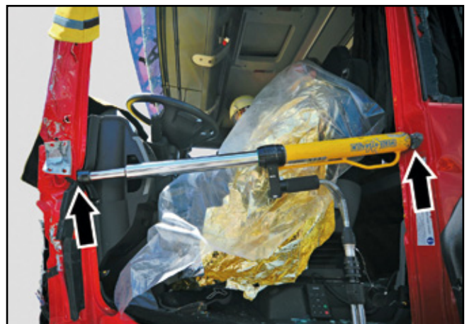
Rettungszylinder ohne Schwelleraufsatz
