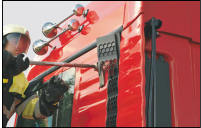
Abdeckung Luftansaugung entfernen
