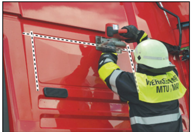
Ausschnitt in die Rückwand sägen
