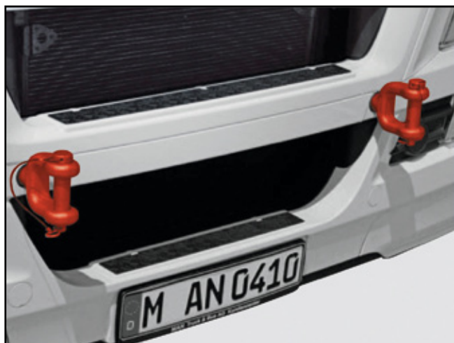
Abschleppösen vorn, beidseitig eingeschraubt
