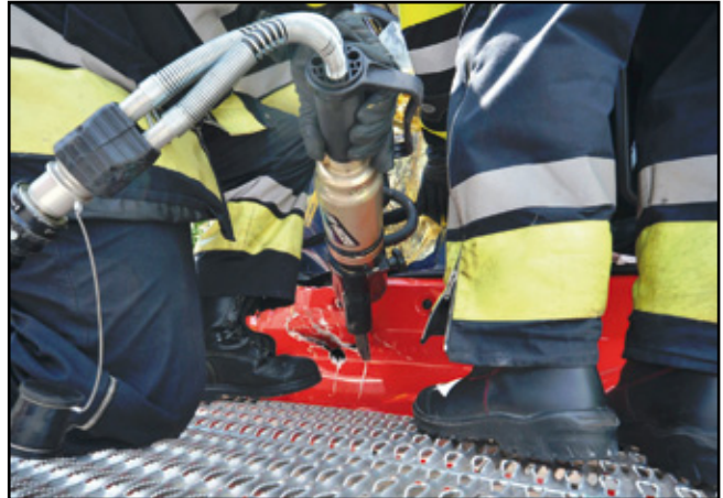
V-Schnitt: Einschnitt schräg von hinten
