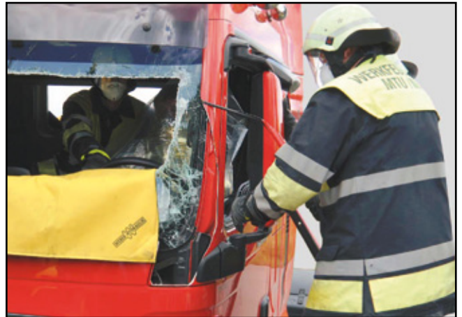
Verkleidung A-Säule entfernen
