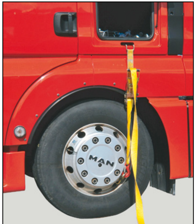
Fahrerhaus sichern über Staufachklappe am Beispiel TGX
