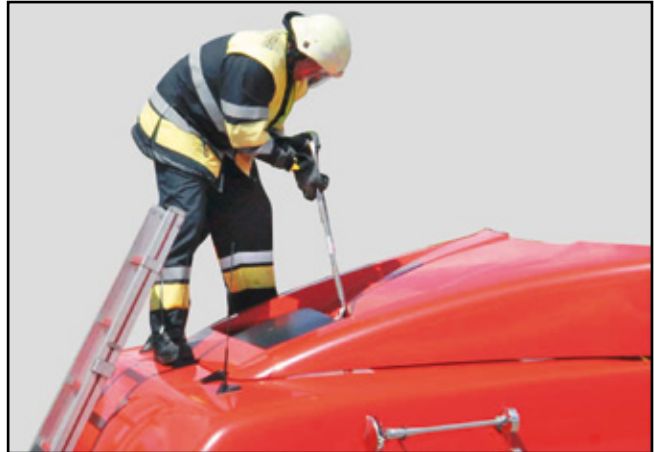
Dachklappe mit Halligan-Tool öffnen
