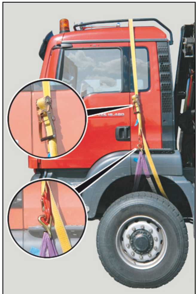
Fahrerhaus sichern am Beispiel TGS
