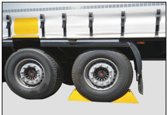
Sicherung mit Radkeilen
