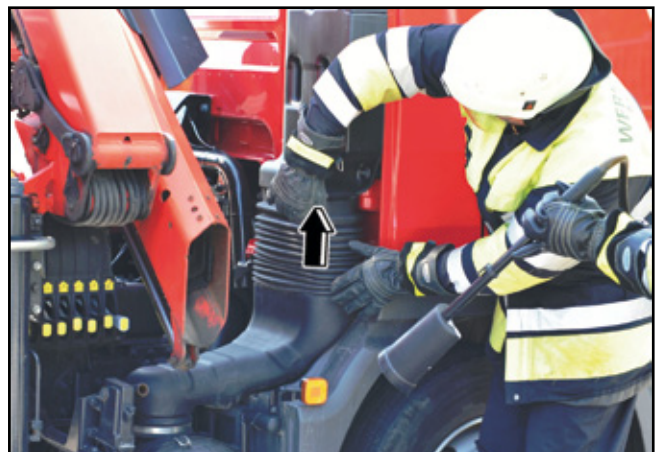
Luftansaugung rechts am Beispiel TGS
