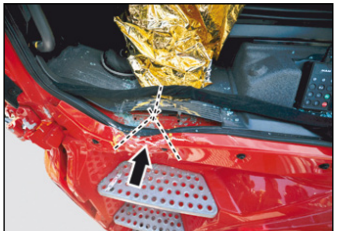
Markierung der Schnitte am Schweller
