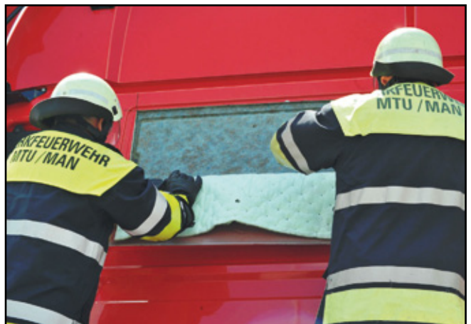
Dämmmatte nach unten klappen
