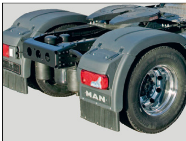
Heckquerträger an einer Sattelzugmaschine
