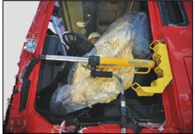
Rettungszylinder mit Schwelleraufsatz
