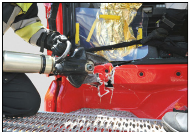
V-Schnitt: Schnitt schräg von vorn
