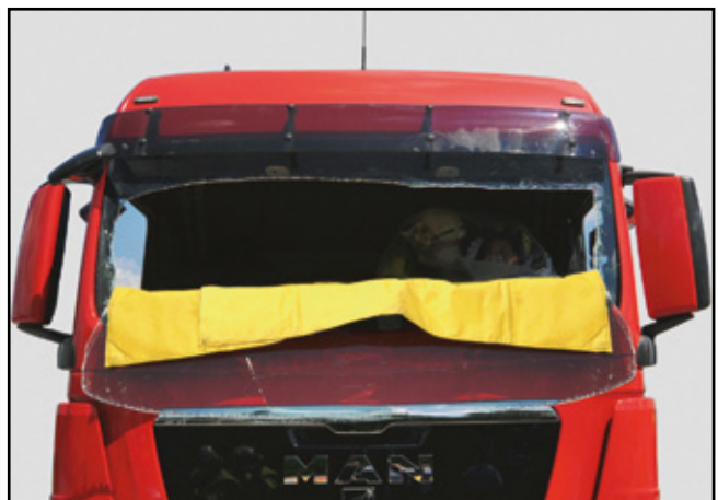
Sicherung mit Schutzdecken
