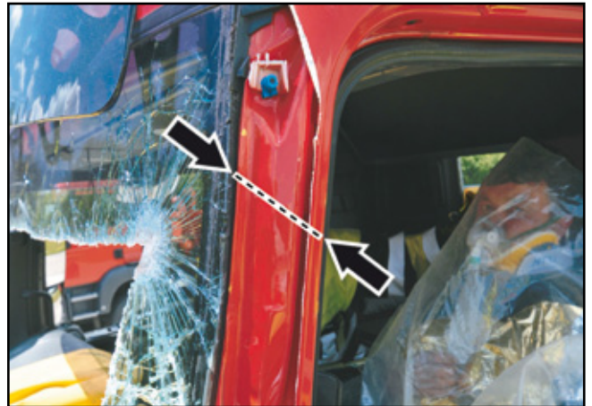
Markierung des Schnittes an der A-Säule
