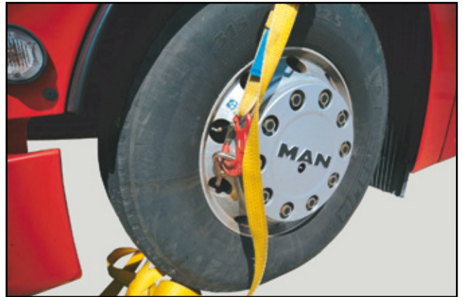
Zurrgurt am Rad befestigen
