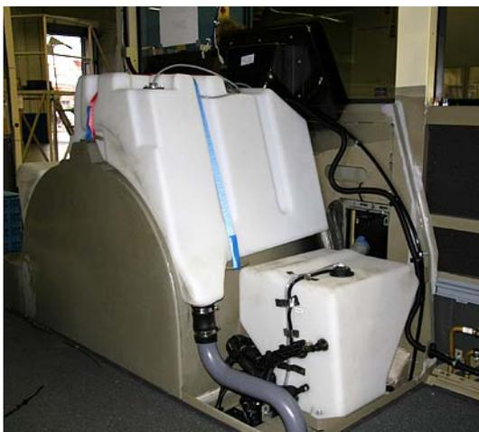
Abbildung 1: Stadtbus - Tank im Rohbau
