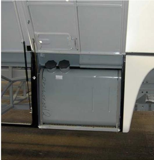
Abbildung 3: Überlandbus - Tank im Rohbau
