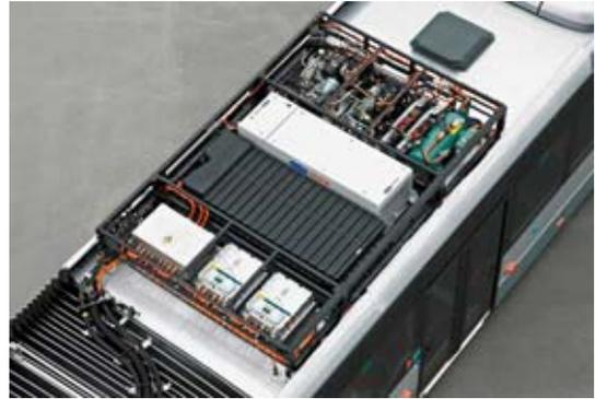
Die Dachkühlanlage auf dem Hinterwagen unterstützt den reibungslosen Betrieb von Motor, Nebenaggregaten und Batterien.
