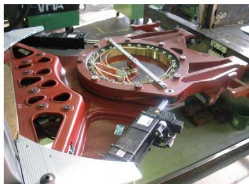
Um Knickbewegungen des Busses zu ermöglichen, sind Vorder- und Hinterteil des Gelenks durch ein Wälzlager verbunden. Die Nickachse befindet sich an der Verbindung zwischen Vorderwagen und Gelenk.
