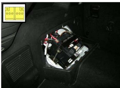
5. Удалите крышку аккумулятора 12 вольт в багажнике и отсоедините аккумулятор.
