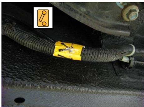
3. Разъедините одно из кабельных соединений на полу автомобиля (желтая этикетка службы спасения)
