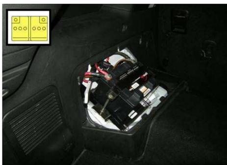
4. Удалите крышку аккумулятора 12 вольт в багажнике и отсоедините аккумулятор.
