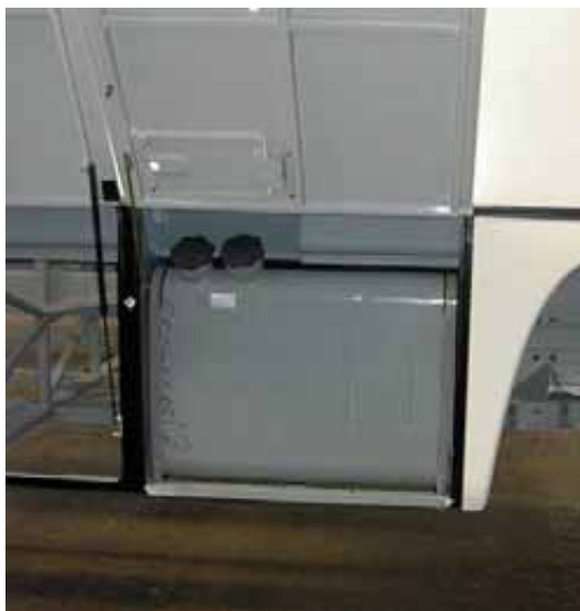
Überlandbus – kombinierter Heizöl- und Dieseltank
