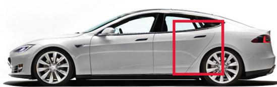
**SCHRITT 2:** Legen Sie eine 12-Zoll-Kreissäge an der Markierung an und sägen Sie die Türsäule bis zu einer Tiefe von 152 mm an.
