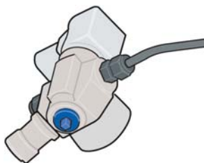
manueller Absperrhahn am Fuß des Flaschenventils.
