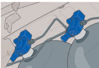
elektromagnetische Absperrventile an den Gastanks
