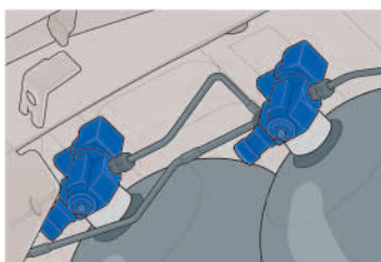
elektromagnetische Absperrventile an den Gastanks
